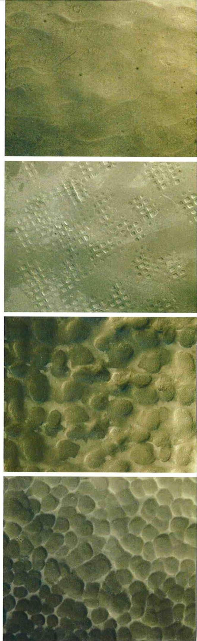
ハンマートーンはロートアイアンの重要な技法で、金属の棒材やプレートの表面に美しいパターンとテクスチャが表現出来ます。しかしこれをデザインとしての有効に取り扱うには、プレーンな部材部分との構成のコントラストが必要です。
